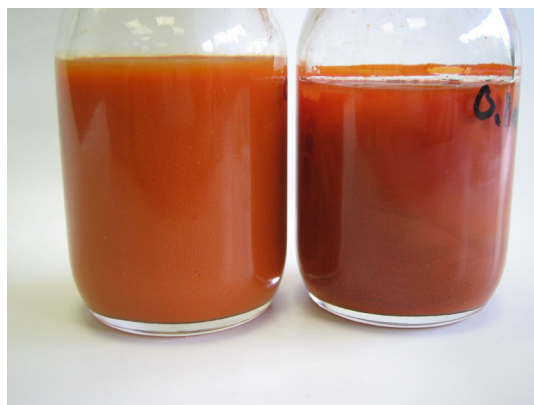
図2 0.1\text{mol/l} の \text{Fe}(\text{NO}_3)_3 水溶液を水熱合成して得られた試料（水溶液） 80^\circ\text{C} 処理（左） 100^\circ\text{C} 処理（右）
