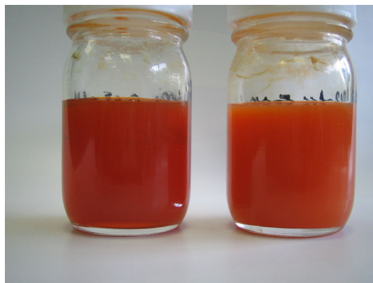
図1 0.02\text{mol/l} の \text{Fe}(\text{NO}_3)_3 水溶液を水熱合成して得られた試料（水溶液） 80^\circ\text{C} 処理（左） 100^\circ\text{C} 処理（右）
