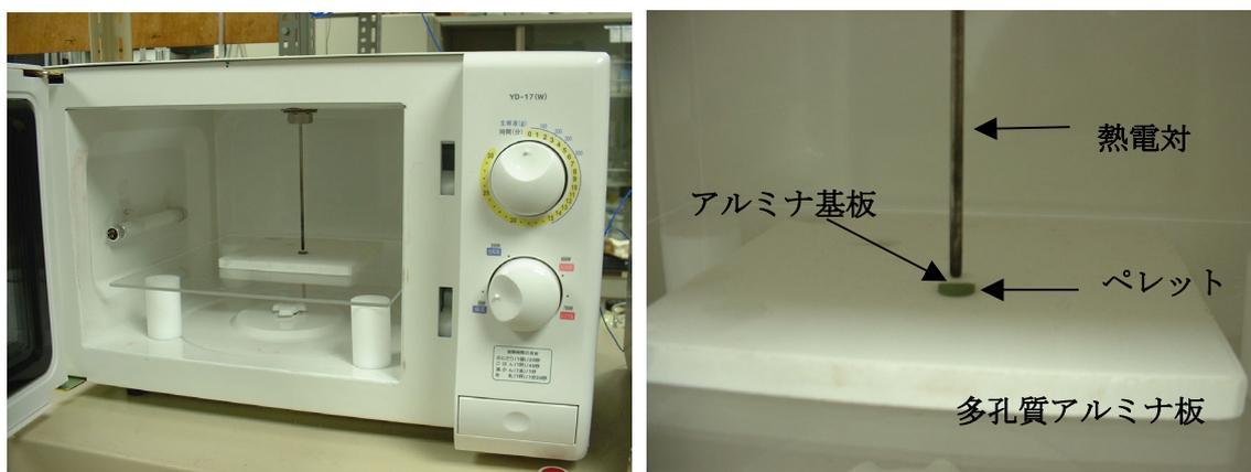
図1 家庭用電子レンジを改造したセラミックス加熱装置
