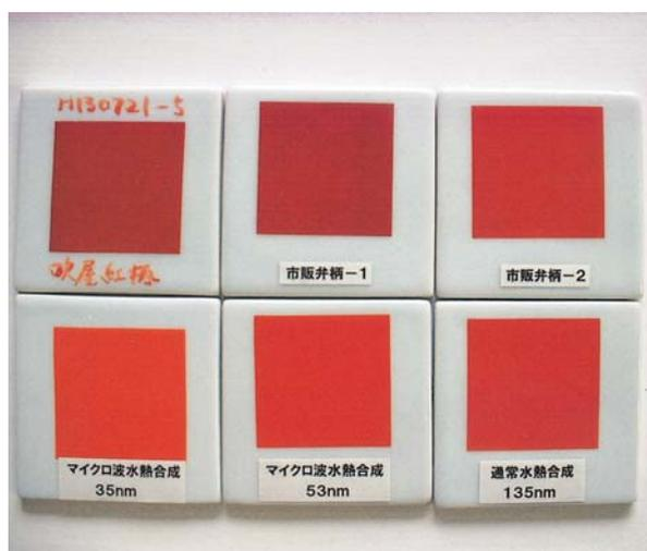
図5 各種 $\alpha\text{-Fe}_2\text{O}_3$ 粒子を用いて作成した赤絵色彩測定用の陶板 (800°C)
