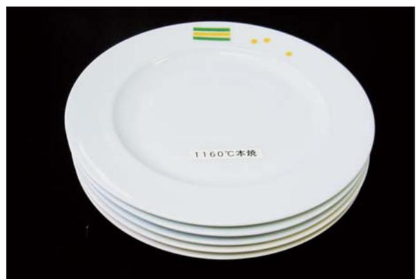
図9 ローラーマシンにより試作した8インチ洋皿
