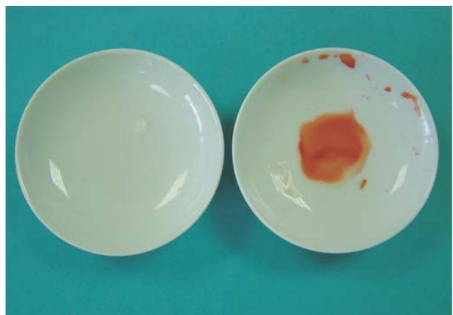
図3 撥水膜シャワー洗浄試験後（920℃焼成）
