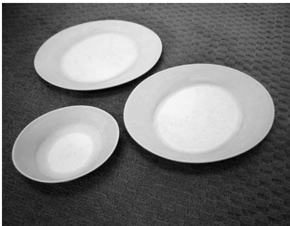
図32 O Dish形状確認用モデル 実写。この後、形状は変更されたが、積層造形品を 原型として製品化された。
