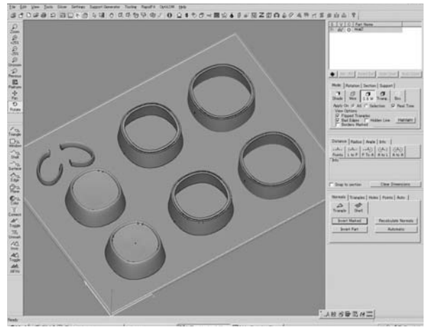
図60 カップ（原型用） Magics画面 カップなどの高さがあるものは、高さを抑えるためと、不要部分を除去するためにも分割する必要がある。
