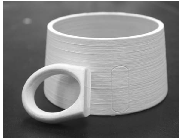
図20 形状確認用モデル マグカップであるが、ボディ側にハンドルとの接合部分を示すケガキ線を入れている。この処理は形状データで行った。
