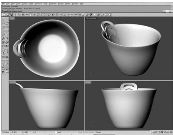
図8 rondeマグカップ Rhinoceros画面 形状データを作り直し、細部を確認している一例。
