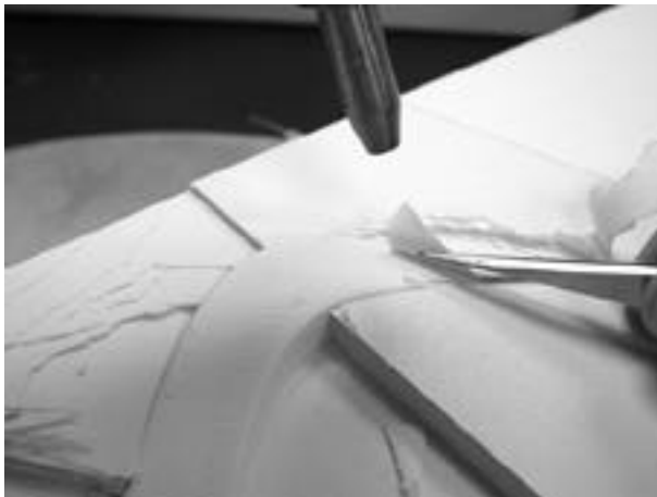
図9 剥離作業の様子 上方はヒートガンのノズル
