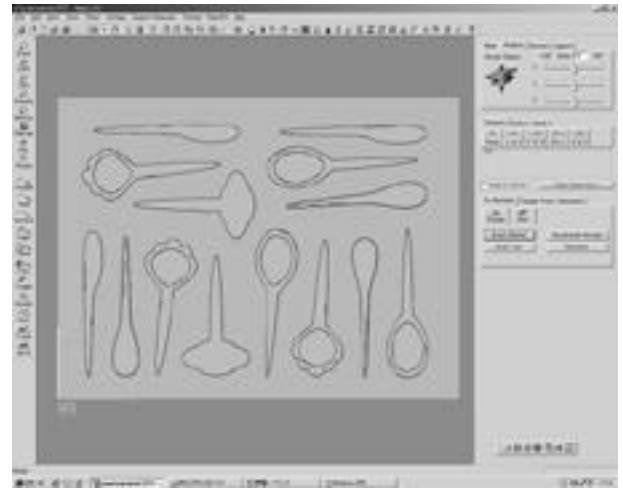
図8 形状データを取り込み、 造型テーブルに合わせて配置した状態 (Magics RP)
