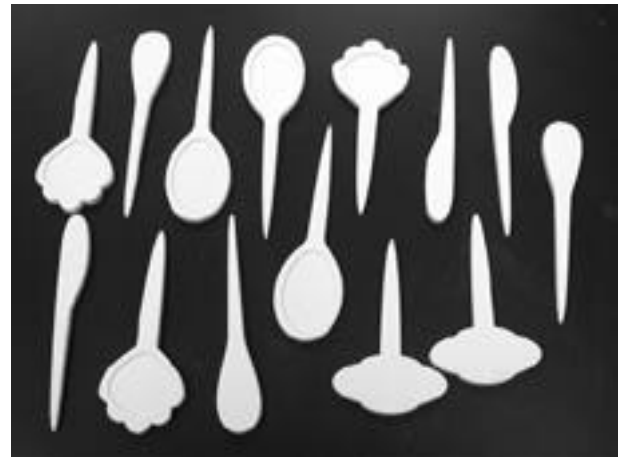
図10 剥離が終了した造形物 一度に造型したもの
