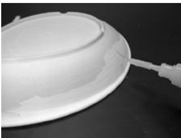
図11 瞬間接着剤を含浸させて硬化
