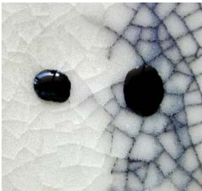
図1 陶磁器表面貫入内の汚れ防止コーティング
