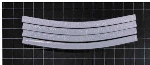
図11 保持時間を変化させた1300°C焼曲試験の結果。
