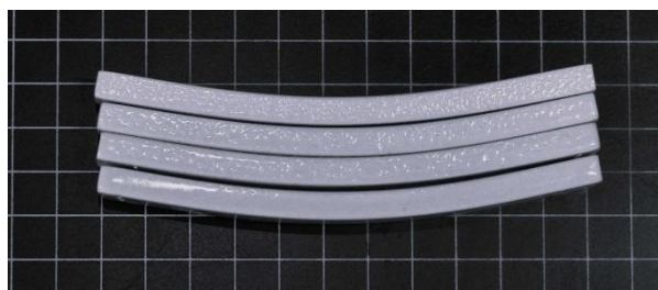
図11 保持時間を変化させた1300℃焼曲試験の結果. (上から15, 30, 60, 120 min.保持 : 昇温速度100℃/h)
