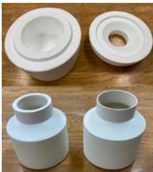
図1 石こう型(上)と成形生地(下). (内径φ60mm、外形φ100mm、H100mm)
