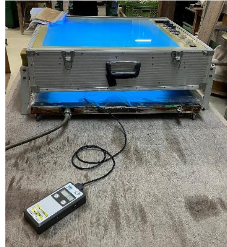
図5 積算光量計による測定の様子。
