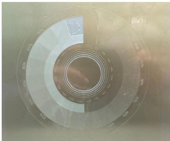
図9 洗浄直後の樹脂が溶け出した状態
