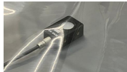
図5 積算光量計による測定の様子。
