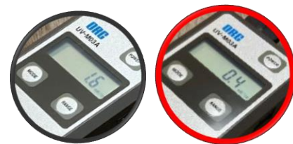
図6 照度測定値結果、右の値がフィルム下の値
