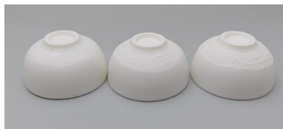
図6 テンプレートの比較(左から高精度、標準、速度重視)。
