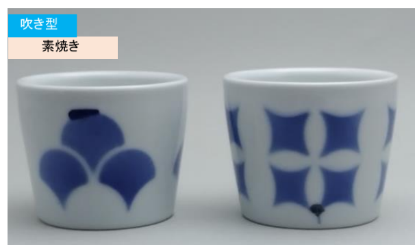
図11 エッジ直角の吹き型の吹付結果。
