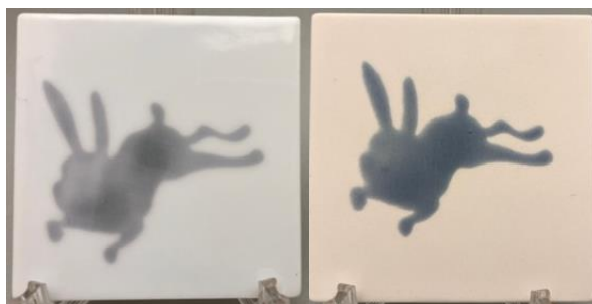
図5 釉薬濃淡印刷の焼成結果(左は太白に転写貼り、右は素地に転写貼り後、1300°Cで酸化焼成したもの)。
