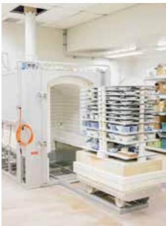
窯室 陶磁器焼成を行います。 主な設備 0.3㎡ガス窯、12KW電気窯2台、15KW電気窯
