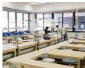
成形室 水挽きろくろ成形や石膏型を用いた各種成形を行います。 主な設備 電動ろくろ、機械ろくろ、圧力鑄込装置、真空土練機、たたら成形機
