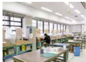
石膏室 図面をもとに量産のための石膏型製作を行います。 主な設備 石膏ろくろ、石膏真空脱泡攪拌機、フライス盤、サンドブラスター
