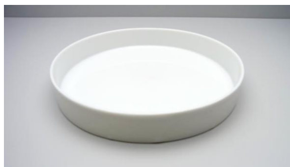
図3 抜け角の小さい圧力鑄込み成形品。
