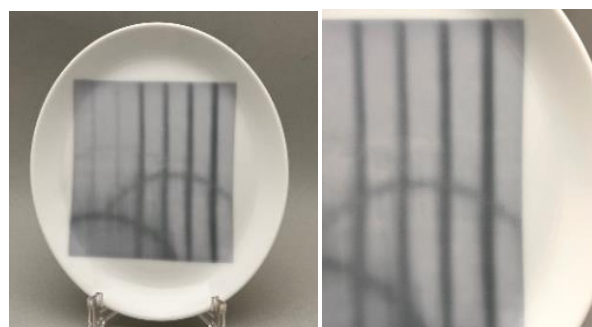
図6 釉薬濃淡印刷の焼成結果(太白に転写貼り後、1300°Cで酸化焼成したもの)。
