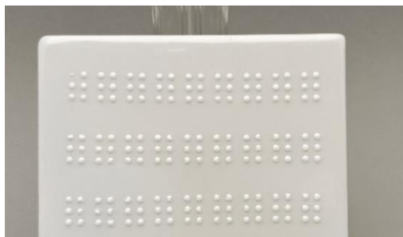
図 10 点字用条件での塗布(焼成後).
