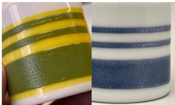
図4 釉薬濃淡印刷の焼成結果(1:0.5の配合)(左は焼成前、右は焼成後)
