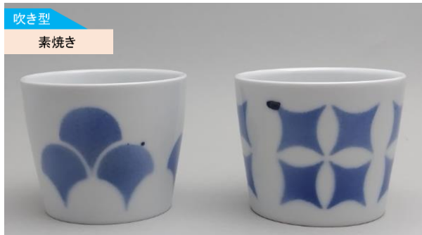
図 12 エッジテーパの吹き型の吹付結果
