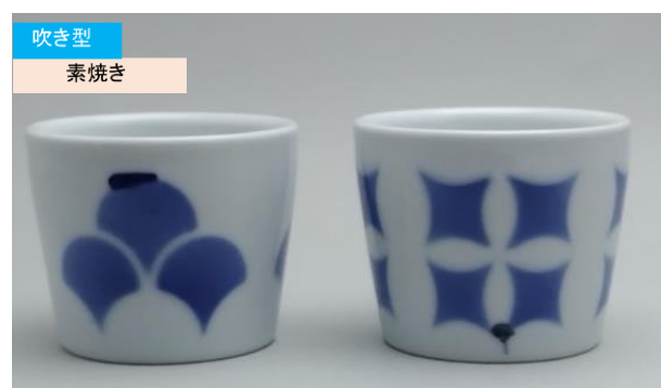
図11 エッジ直角の吹き型の吹付結果
