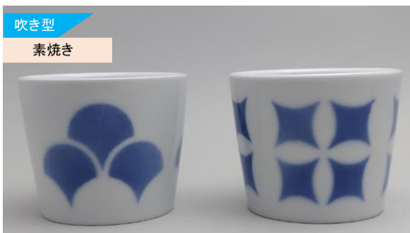
図 14 エッジ逆テーパの吹き型の吹付結果
