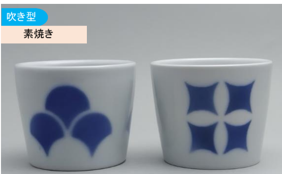
図 13 エッジ楕円の吹き型の吹付結果
