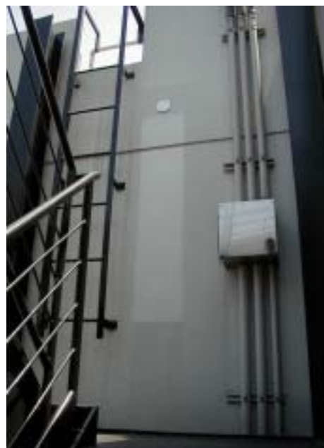
ビル外壁の防汚試験。真ん中四角のコーティング部分は汚れない。
